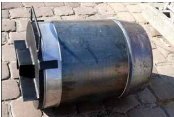
Schmelzbasaltrohr mit Kalibrierkopf und Druckplatte
